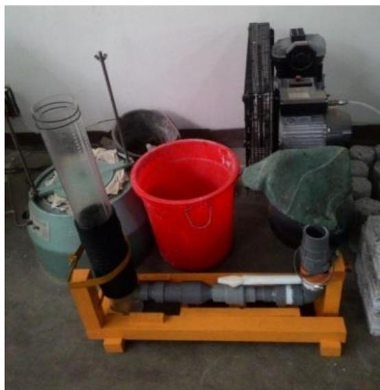
Gambar 2. Alat Pengujian Permeabilitas
