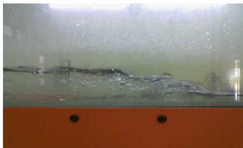
Gambar 3. Hasil pengamatan di laboratorium untuk Q_{0,001955} dan a_{0,025} ( Fr_1 = 2.5 - 4.5 )
