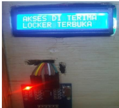
Gambar 8 Hasil tap kartu yg terdeteksi benar dan LCD dalam kondisi baik
