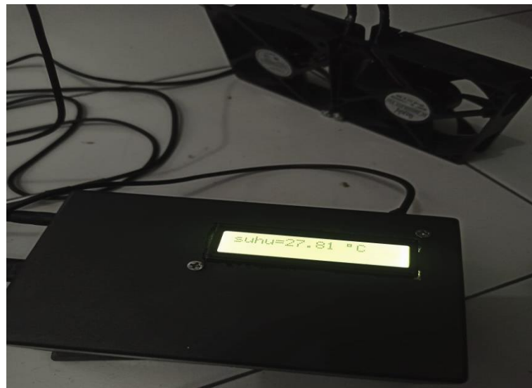
Gambar 10. Kipas berhenti ketika suhu di bawah 28 °C
