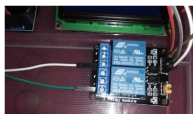
Gambar 6. Tampilan Relay Sebagai Saklar Elektrik
