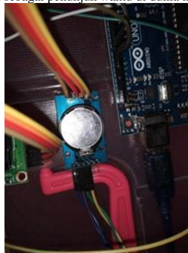
Gambar 4. Tampilan Sensor Sebagai Real Time Clock
