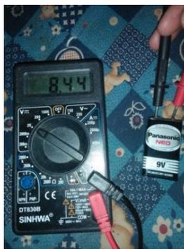
Gambar 17. Pengujian tegangan catu daya menggunakan baterai 9v
