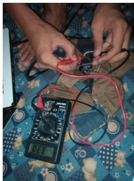
Gambar 18. Pengujian tegangan catu daya menggunakan NodeMCU
