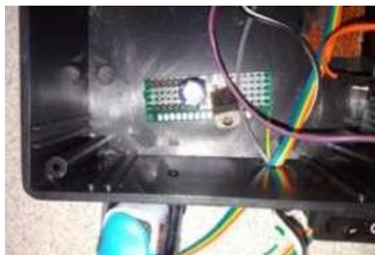
Gambar 10. Posisi Pemasangan Power Supply
