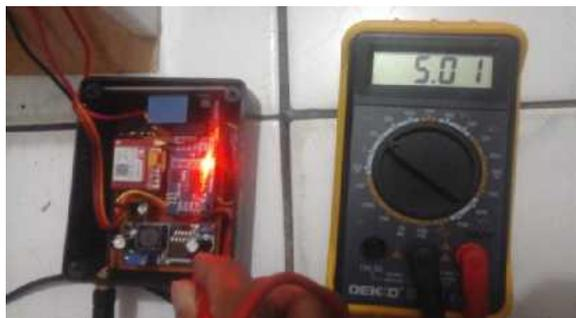
Gambar 10. Pengujian tegangan output regulator 5 volt
