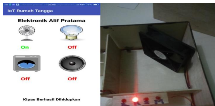
Gambar 11. Contoh pengujian kipas hidup
