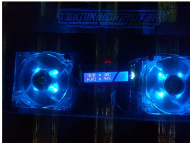
Gambar 9. Pengujian FAN / Kipas dengan suhu >28C
