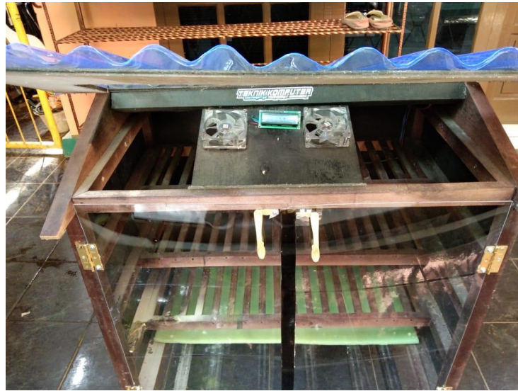
Gambar 7. Alat penjaga kestabilan suhu jamur tiram
