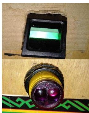
Gambar 19. Pemasangan Sensor Infrared
