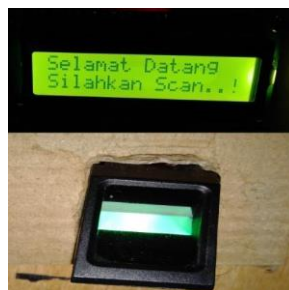
Gambar 16. Pengujian module fingerprint
