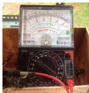
Gambar 13. Pengukuran tegangan dengan multimeter
