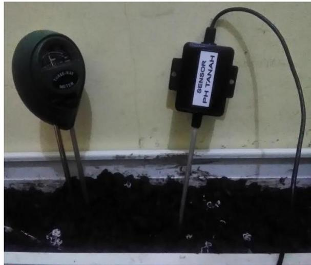
Gambar 15. Pengujian Sensor pH Tanah dengan pH Meter
