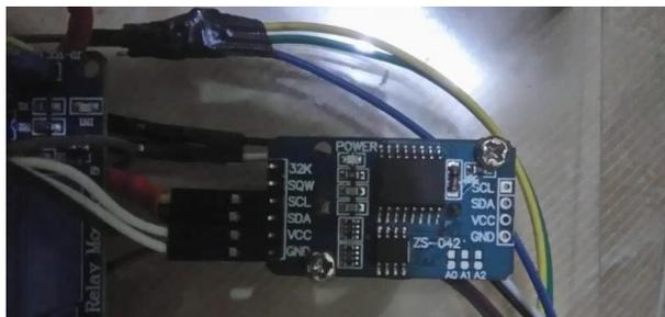
Gambar 11. Rangkaian Modul RTC Pada Implementasi Alat
