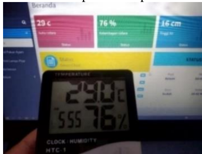
Gambar 9. Pengujian Suhu dan Kelembapan Udara
